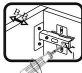
Если нижняя или верхняя часть створки отстает от корпуса, нужно ослабить винт 1 и сдвинуть створку в направлении В-В, а затем затянуть винт 1.
