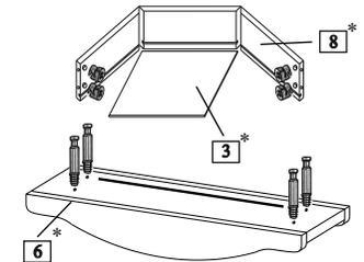
В накладку ящика вворачивается дубель эксцентриковой стяжки. Ящик складывается согласно схеме, в паз вставляется дно, накладка стягивается с корпусом ящика. **Предварительно просверлив отверстия Ø 2,5 мм**, крепятся направляющие шурупами 4x13. Шурупом 4x16 через фиксатор приворачиваем дно ящика (рис. №7)
